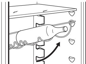
Полку для бутылок можно наклонить, для того чтобы хранить в ней открытые бутылки. Для этого передвиньте передние зацепы полки на один уровень выше задних.
