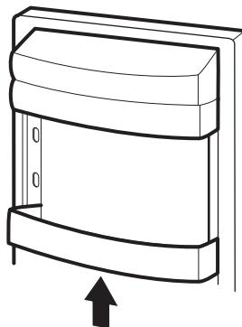
Чтобы обеспечить возможность хранения упаковок продуктов различных размеров, навесные полки дверцы можно размещать на разной высоте.
