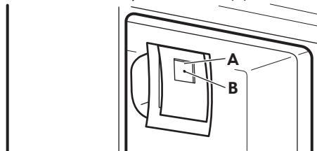
2. Funkciu chladenia ventilátorom vypnite stlačením spínača (A).
