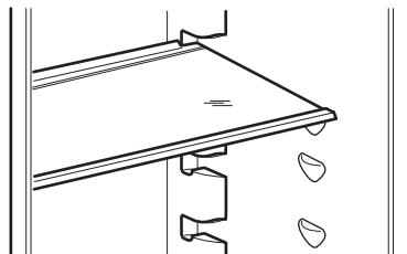
На стенках холодильника установлен ряд направляющих, позволяющих по желанию размещать полки из безоскокового стекла.
