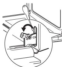
Поднимите и поверните рычажки, расположенные в обеих петлях, при помощи отвертки.
