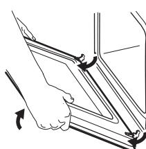
Прикройте дверцу наполовину до первого фиксируемого положения. Затем вытяните дверцу вперед из ее гнезда.
