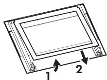
Сначала осторожно поднимите и выньте стеклянную панель. Чтобы снять дверную планку, потяните ее вперед. Вымойте стеклянную панель водой с мылом. Осторожно вытрите стеклянную панель досуха.
