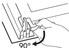
Отожмите стопоры, чтобы снять внутреннюю стеклянную панель. Поверните два фиксатора на 90°.
