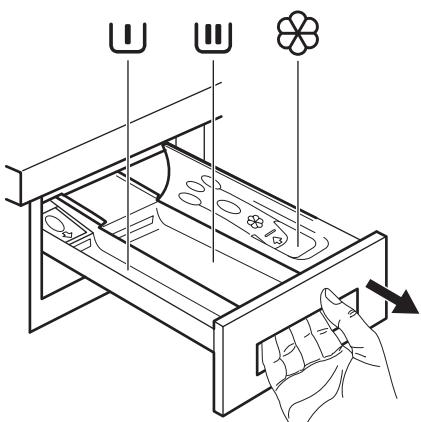
Отделение для моющего средства, используемого на этапах предварительной стирки и замачивания. Моющее средство для предварительной стирки и замачивания добавляется в начале выполнения программы стирки.
