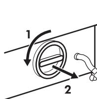
Когда вода перестанет литься, отвинтите крышку фильтра и снимите ее. Обязательно держите под рукой тряпку, чтобы вытереть воду, которая может пролиться при снятии фильтра. Извлеките предметы из крыльчатки насоса, проворачивая ее.
