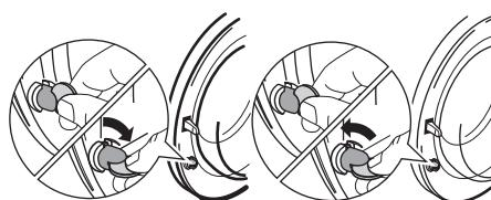
Для включения этого устройства поверните по часовой стрелке кнопку с внутренней стороны дверцы (не нажимая ее) так, чтобы паз пришел в горизонтальное положение. При необходимости используйте для этого монету.
