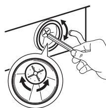
С помощью карандаша проверьте, может ли свободно поворачиваться крыльчатка насоса на задней стенке отсека фильтра. (Крыльчатка может вращаться рывками; это нормально.) Если колесо насоса невозможно повернуть, обратитесь в авторизованный сервисный центр. Вставьте заглушку обратно в шланг аварийного слива и установите его на место. Завинтите фильтр до упора.
