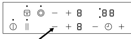
Одновременно коснитесь + и - соответствующей конфорки для ее отключения. Настройки изменятся на .
