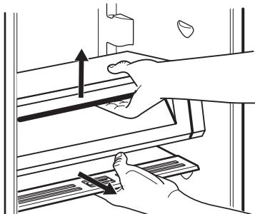
3. Возмитесь за ящик секции низкой температуры и одновременно за его
