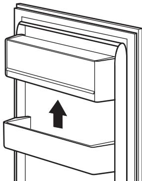
Чтобы обеспечить возможность хранения упаковок продуктов различных размеров, навесные полки дверцы можно размещать на разной высоте.
