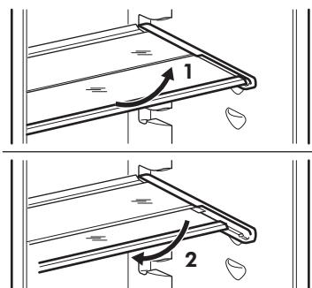
Расположенные на стенках холодильника направляющие позволяют размещать полки на нужной высоте.
