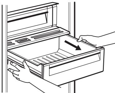
2. Приподнимите секцию низкой температуры и извлеките из-под нее стеклянную крышку с регулировкой влажности.
