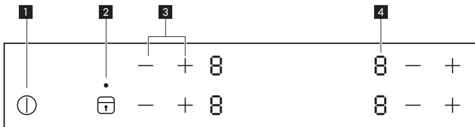
Cihazı çalıştırmak için simgeye basın. Göstergeler ekranı, göstergeler ve sesler hangi işlevin çalışmaktan olduğunu bildirir.
